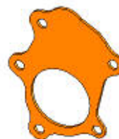
12208 T-28 DISCHARGE FLANGE
